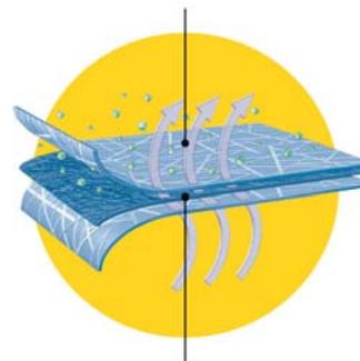
Внутренние слои – сложная структура из микрофибры, отфильтровывающая большинство водных растворов химикатов и твердые частицы
