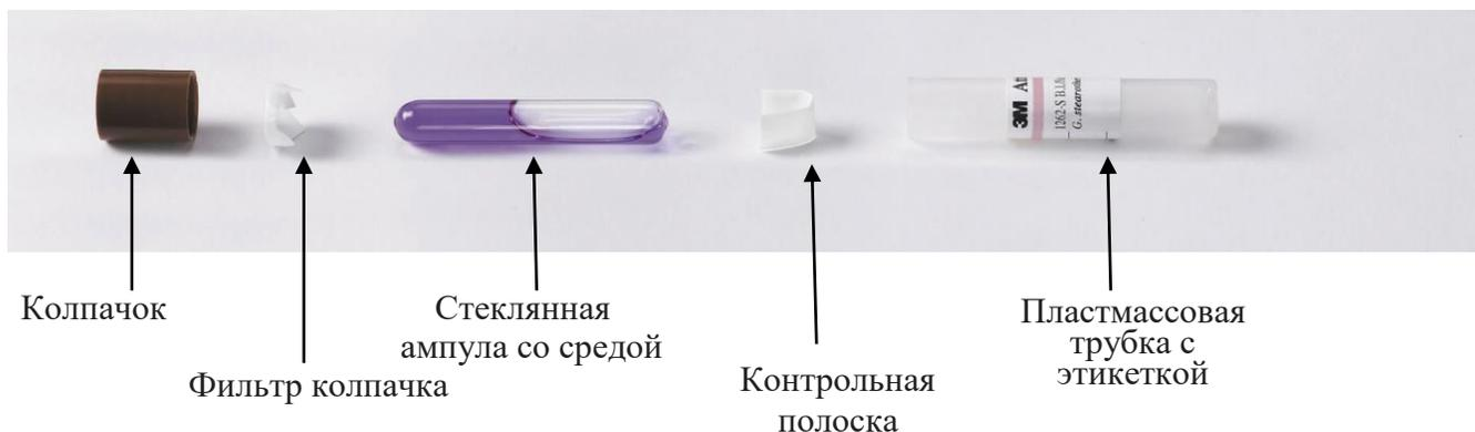
Рис. 1 – Компоненты Attest 1262-S производства 3M
