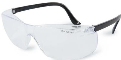
Современные легкие универсальные очки JSG911-C Clear vision с панорамным защитным стеклом из поликарбоната и покрытием против царапин и запотевания, предназначены для защиты глаз спереди, сверху и с боков от механических воздействий, абразива, УФ-излучения. Очки эргономичны и конструктивно совместимы с различными видами СИЗ. Литая конструкция минимизирует вероятность поломки.
